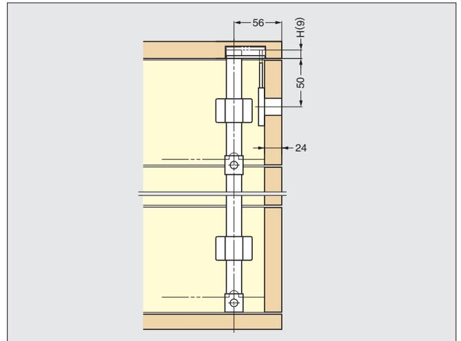
上の取付仕様図においては、運動バーとシリンダー錠のデッドボルトとのすき間を約5mmとっているため、運動バーの上下のストロークHは約9mmになります。
