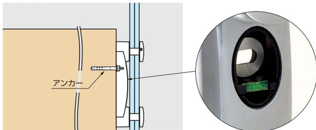
本体に内蔵の水準器で水平が出ていることを確認し、アンカーで本体を固定します。
