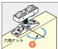
六角ナットを緩めた後、ハンガーボルトの穴にアジャーストピン⑥を差し込み回転させ、調整します。
