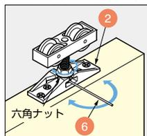
六角ナットを緩めた後、ハンガーボルト<sup>2</sup>の穴にアジャストピン<sup>6</sup>を差し込み回転させることにより調整が行えます。
