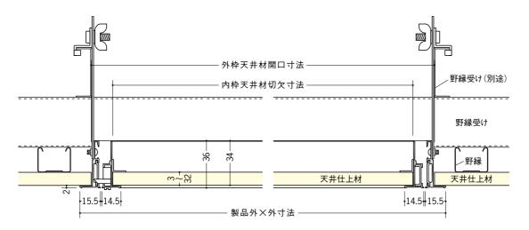
Superリーフ909vs吊り金具タイプは、 おのずと内枠の重量が重くなりますので、 開閉時及び内枠を取り外す際は、 十分注意して下さい。 内枠落下防止用の ワイヤーもご用意しています。 詳しくは516ページです。
