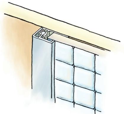
アルミキッチンパネル用ジョイナー カラーは、「建築用アルミニウム合金材料 焼付け塗装標準仕様書」の仕様に基づいて焼付け塗装を行っています。
