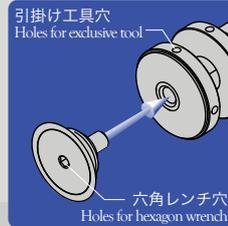
皿穴形状なのでガラス面に突出がなくフラットに収まります。スマートな空間演出が可能です。前面から締め込み、取り付けます。
